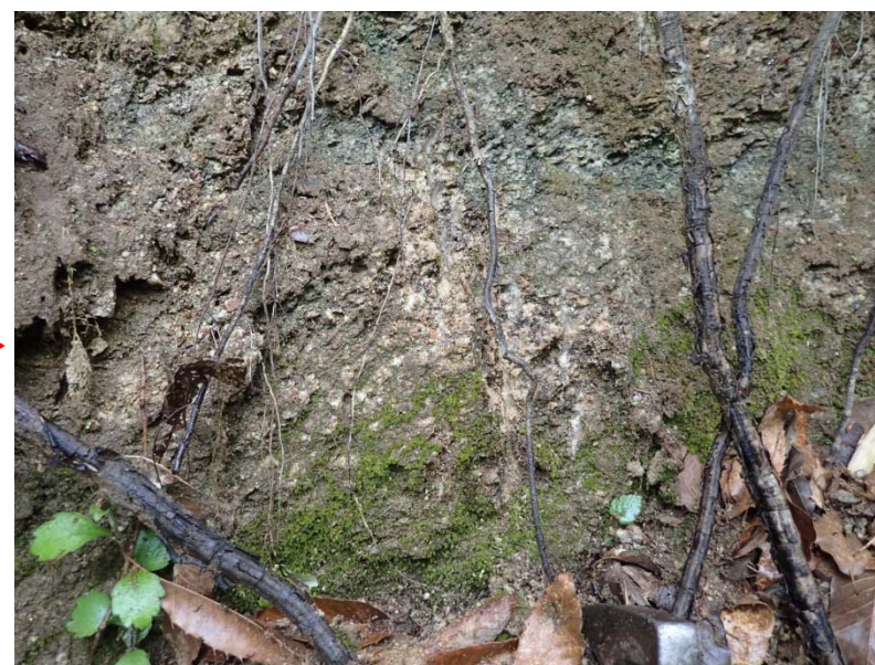
写真-005 同 左 (拡大) D M級の風化。
