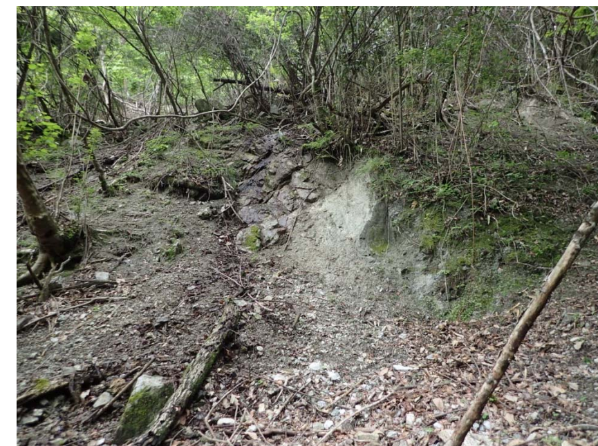
写真-007 半の沢上流部の状況。割れ目の発達する花崗岩と粘土化したマサ（写真の白色を帯びる部分）が分布する。
