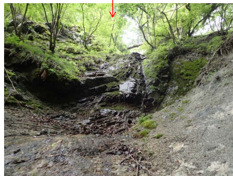
写真-016 同上。変質した花崗岩の上部には硬質な花崗岩が分布。
