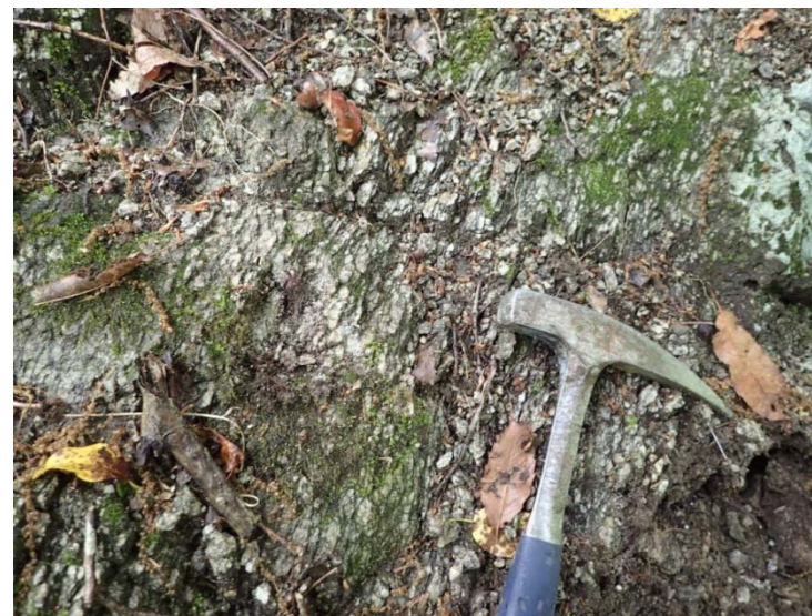
写真-002 同 上 (拡大) D H級の風化。
