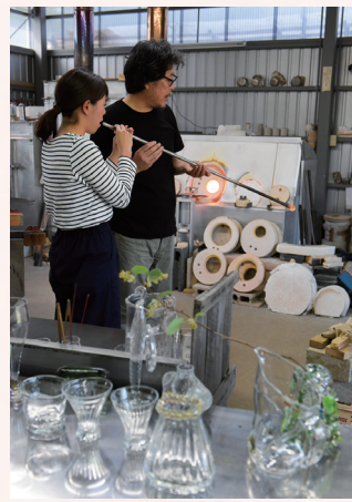
窯の温度は1,140度ほど。窯から出すと10秒ほどで固まり始めます。「気に入ったカタチになったら、どこでおしまいにするか見極めるのも大事だよ……」とアドバイザー。
